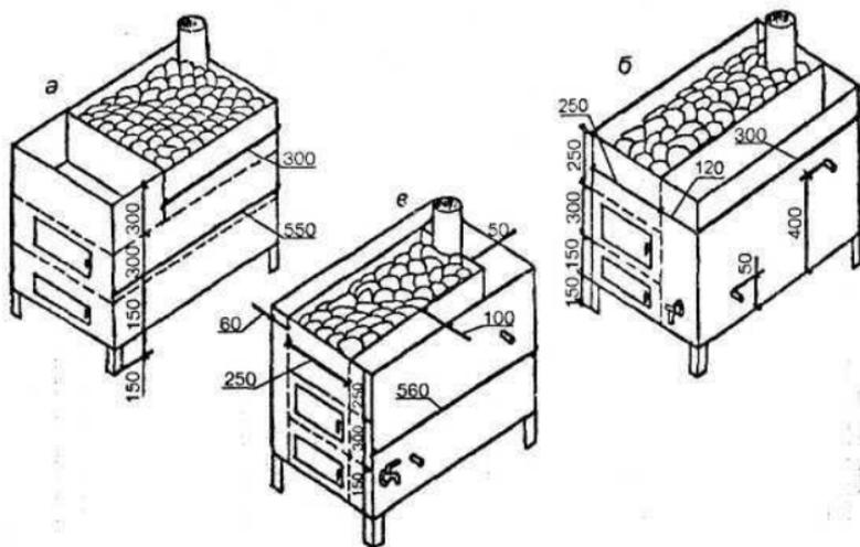
*Рис. 2. Печи-каменки с встроенным баком для воды:*
