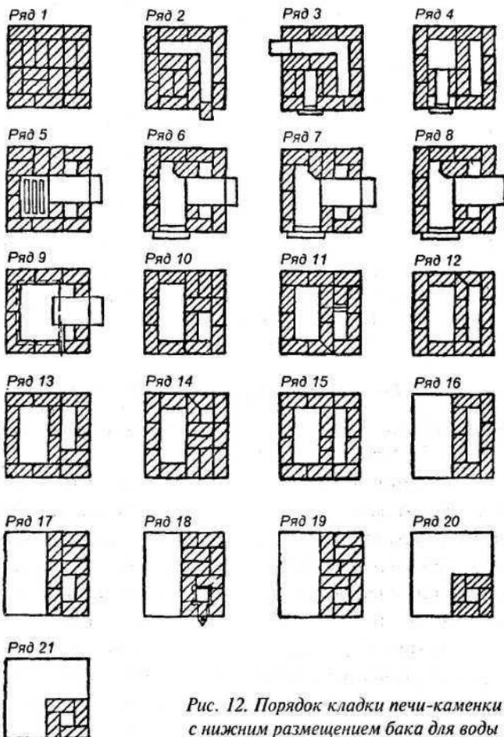
*Рис. 12. Порядок кладки печи-каменки с нижним размещением бака для воды*
