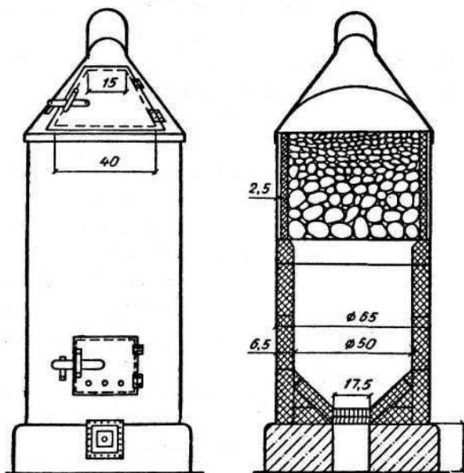
*Рис. 7. Общий вид и поперечный разрез печи-каменки в виде бочки*
