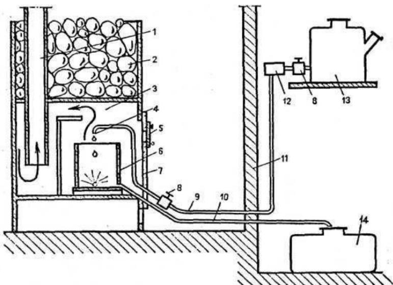
*Рис. 4. Схема применения горелки с разбрызгиванием топлива:*
